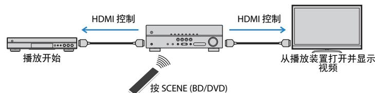
若要用 HDMI 控制，您需要在连接电视和播放装置后执行以下 HDMI 控制链接设置。有关电视的设置和操作的详情，请参见电视使用说明书。
